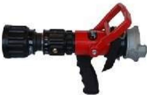
Стволы пожарные ручные СРП-50р ТУ У 28.2-319162162-009:2013 предназначены для формирования и направления сплошной или распыленной струи воды, воздушно-механической пены средней или низкой кратности, а также для перекрытия подачи огнетушащих веществ. Стволы имеют бесступенчатую регулировку угла фокуса распыла от прямой компактной струи до защитной завесы в 120°, а также регулировку расхода воды с фиксированным положением позиций. Стволы применяются для комплектации передвижной пожарной техники.
