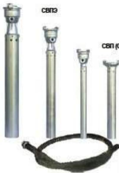
Воздушно-пенные стволы типа СВП (СПП) ДСТУ 2107-92 и СВПЭ-2,4, 8 ТУ У 14317031.003-95 предназначены для получения воздушно-механической пены из водного раствора пенообразователя, формирования и направления ее струи при тушении пожара.
