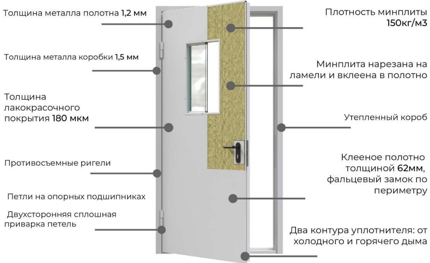
ООО "Звенотекстиль" производит двери по технологии сэндвич-панелей. Дверное полотно заполняется ламелями минеральной плиты плотностью не менее 150 кг/м3. Ламели плотно укладываются в полотно на клей. Термопресс склеивает все компоненты в единую плиту.
